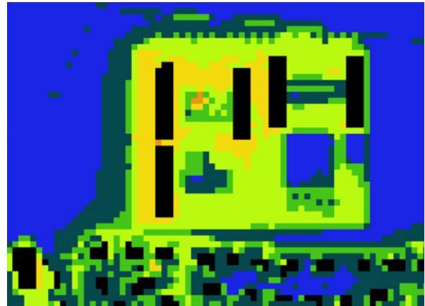
Nächtliche Lufttemperatur in 2 m über Grund: Vollversiegelung und Bebauung bilden eine Wärmeinsel, Freiflächen kühlen effektiv ab.
